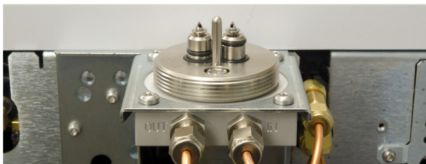
Abbildung 15. Für eine Konfiguration mit PAL automatischem Probengeber auf der Unterseite der Halterung montierte Halterungsanschlusseinheit
