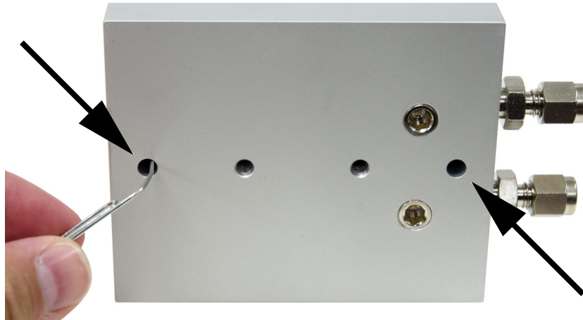
Abbildung 2. Entfernen der Kunststoffkappen von der Anschlusseinheit
