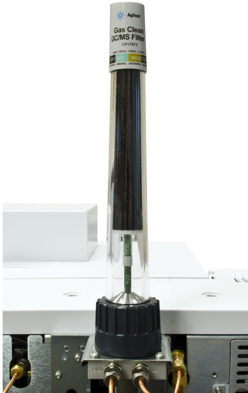
Abbildung 35. Trägertgasfilter, der an der Halterungsanschlusseinheit montiert ist (7890 dargestellt)
