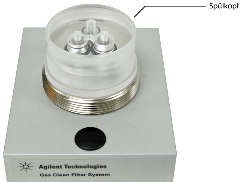
Abbildung 25. Verwenden des Spülkopfes zum Spülen der Gasleitung, um Sauerstoff und Feuchtigkeit zu entfernen
