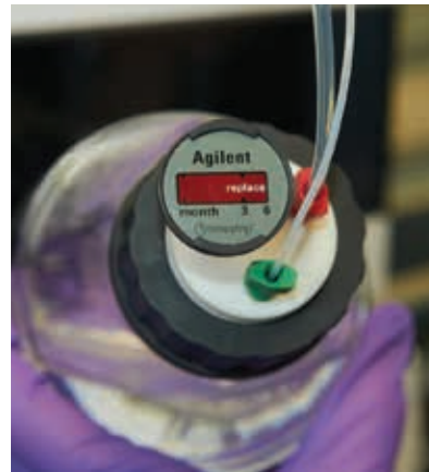
Praktische Filteranzeige: Der Zeitstreifen zeigt an, wann der Filter ausgetauscht werden muss.
