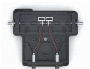
InfinityLab Max-Light HDR Durchflusszelle, Innenansicht, zur Illustration der geringen Schichtdicke von 3,7 mm für hohe Konzentrationen, G4212-60032
