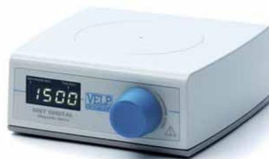
Kleiner, leichter Magnetrührer für Rührmengen bis 5 l.
