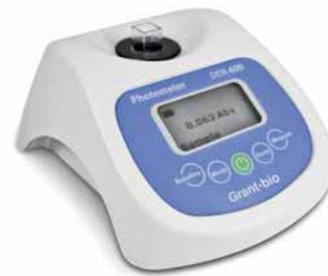
Tragbares Dichtemessgerät für die OD600-Methode, McFarland-Methode (McF) zur Messung der Trübung und die Bradford-Protein-Assay-Methode zur Bestimmung der Proteinkonzentration.
