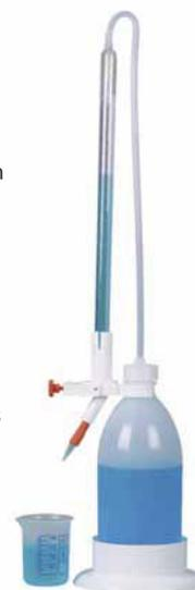
Titrierbürette mit Splitterschutz nach Dr. Schilling, mit Schellbachstreifen, automatischer Nullpunktabsaugung und Bürkle-Dosierarmatur.
