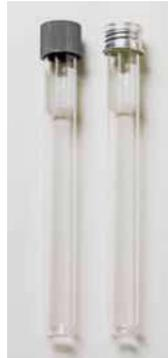
Starkwandig 1,1 mm. Weithalsig, daher leicht zu beimpfen und zu reinigen. Komplett mit Aluminium-Schraubverschluss (autoklavierbar/sterilisierbar) oder Kunststoff-Schraubverschluss (dampfautoklavierbar bei 121 °C/sterilisierbar) und Gummidichtung.
