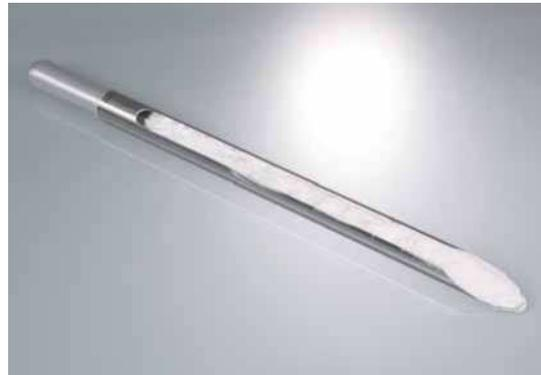
Universeller Pulver- und Granulatsammler, aus Edelstahl V4A. Ursprünglich, speziell für Milchpulverproben entwickelt, normgerecht, entsprechend DIN und IDF (International Dairy Federation). Der Sammler wird in Säcke oder Tonnen eingestochen und die Probe mit der halbschalenförmigen Lanze entnommen. Autoklavierbar.
