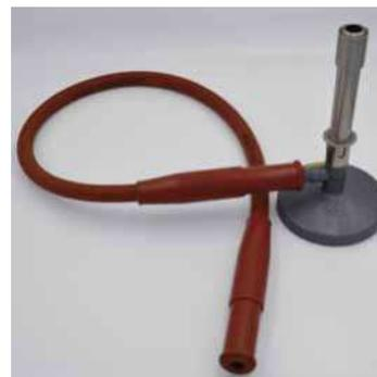
Bewegliche Anschlussleitung aus einem Gummischlauch mit einer eingezogenen Metallspirale sowie beidseitigen Endmuffen nach DVGW G 5501 (P). Knickfest. Zur Verbindung zwischen Sicherheits-Gas-Anschlussarmatur nach DIN 3383-4 und Gasbrenner für Laboratorien nach DIN 30665 Teil 1.
