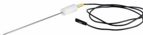
Der Temperaturfühler kann an der Buchse des Ultraschallwandlers angeschlossen werden.
