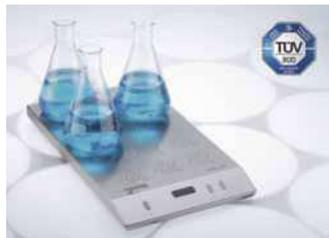
Ohne Heizung. Mit 100 % verschleiß- und wartungsfreiem 2mag-Induktionsantrieb. Mit 15 Rührstellen, für z. B. 6 x 1-Liter Erlenmeyerkolben oder 15 Bechergläser à 250 ml (hohe Form). Für Reihenuntersuchungen und biologische Applikationen. Digitale Drehzahlanzeige. SoftStart bei Rührbeginn. 3 Jahre Gewährleistung. Made in Germany.
