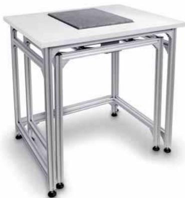
Konstruiert, um Erschütterungen und Schwingungen zu absorbieren, die sonst das Wägeregebnis verfälschen würden. Mit einer auf Gummielementen gelagerten Granit-Steinplatte, die Standfläche für eine Analysenwaage dient. Die Arbeitsplatte umschließt die Steinplatte und bietet viele Ablagemöglichkeiten.
